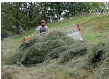
*Au-dessus d'obstacles, il est recommandé de travailler dans un premier temps en position de transport pour acheminer les produits de fauche secs vers une zone plus facile d'accès. Il est ainsi possible de collecter et de transporter très facilement de grandes quantités de fourrage en suivant la courbe de niveau ou en pente montante. Par la suite, il est de nouveau possible de travailler en continu en suivant la courbe de niveau en pente descendante.*
