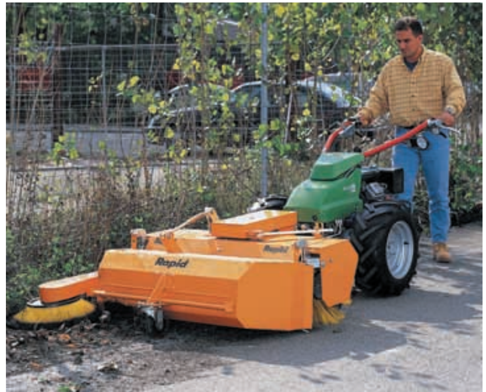
Rapid Euro-Combi mit Kkehrbürste und automatischer Schmutzaufnahme.
