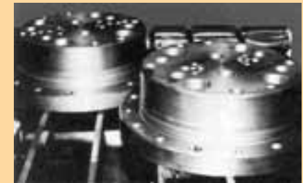
Druckstücke aus hochlegiertem Kaltarbeitsstahl. Werkstoff-Nr. 1.2363.
