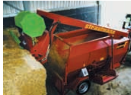
Futtermischwagen mit Entnahme fräse.
