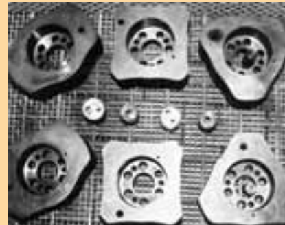
Feinstanzstempel aus Schnellarbeitsstahl. Werkstoff-Nr. 1.3343.
