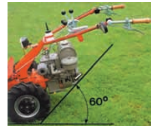
Rapid Mäher 306: Grosse Bodenfreiheit erleichtert das Fahren im Gelände.
