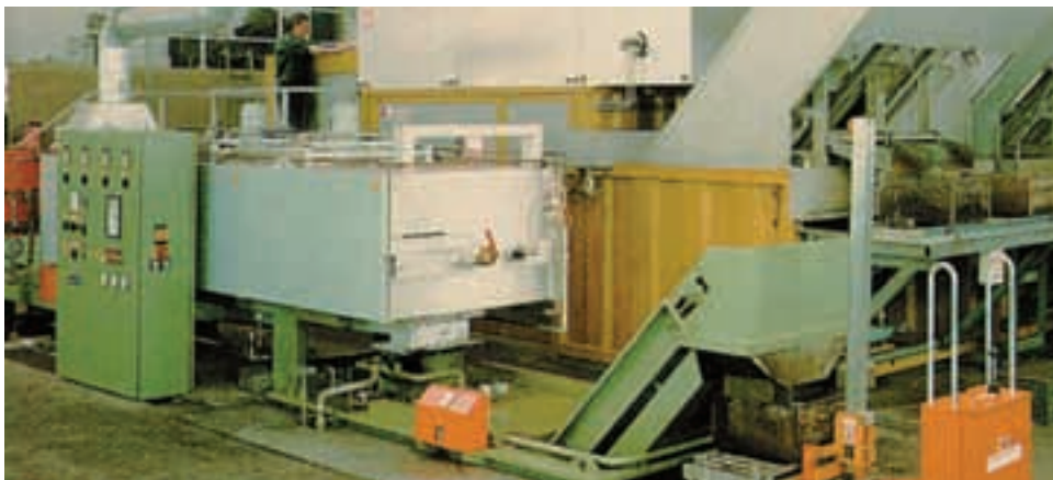
Härtedurchlaufanlagen mit Schutzgasatmosphäre.
