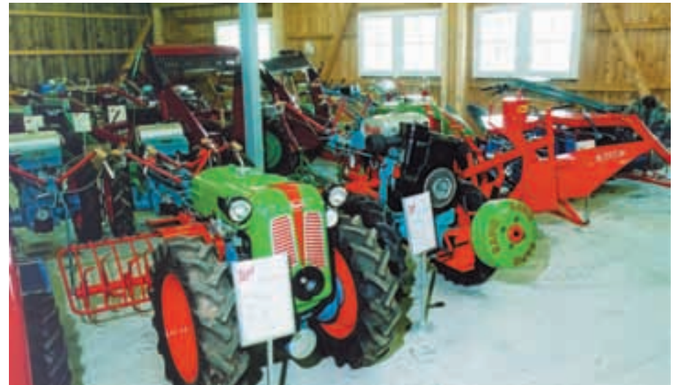
Sammlung von Rapid Motormähern, im Vordergrund zwei Modelle des berühmten Einachstraktors Rapid S mit Bodenhacke (links) und mit Bindemäher (ganz rechts).
