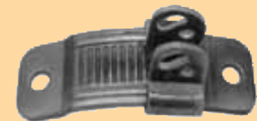
Skischuh-Schnalle, im Durchlaufofen karbonitriert.
