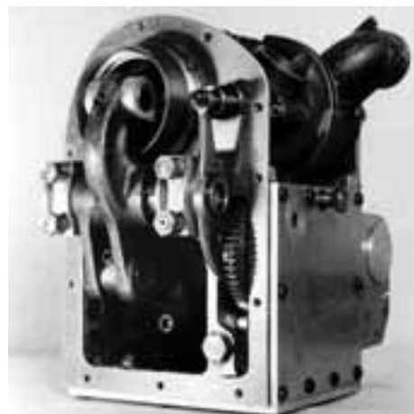
Leistungsstarker Viertaktmotor des Rapid-Autos.
