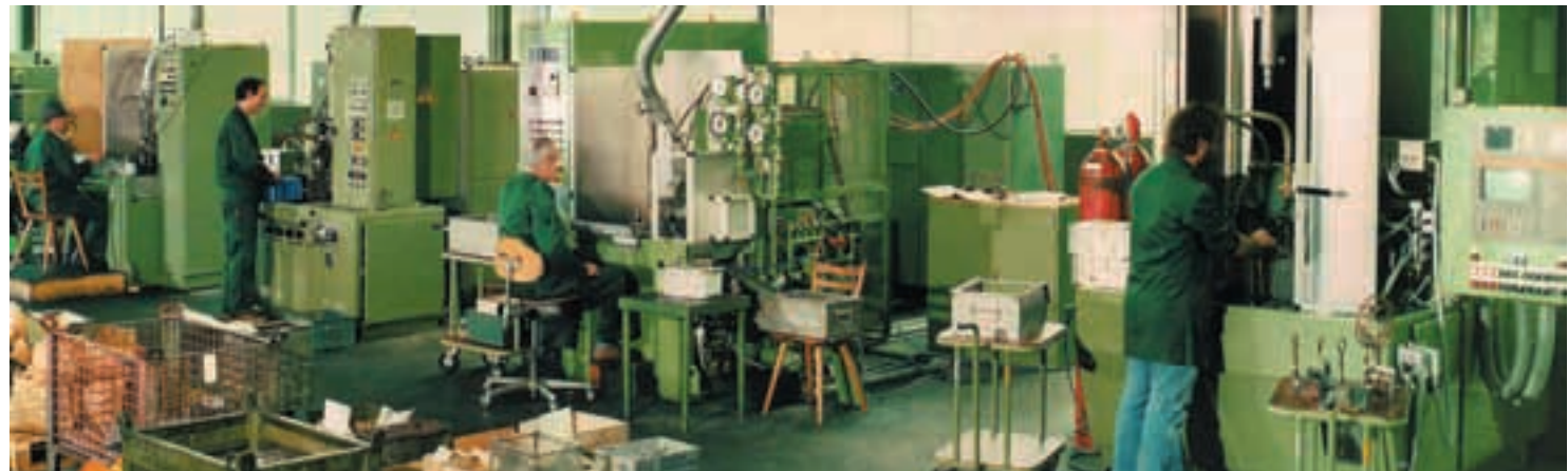
CNC-gesteuerte Induktions-Härteanlagen im Betrieb Wehingen.
