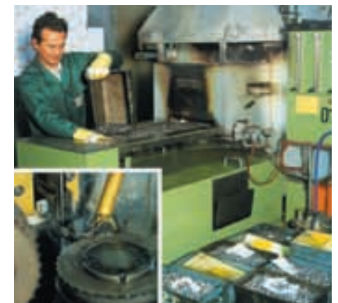
Angepasste Härteverfahren (Induktivhärten bzw. Einsatzhärten im Durchgangsofen).
