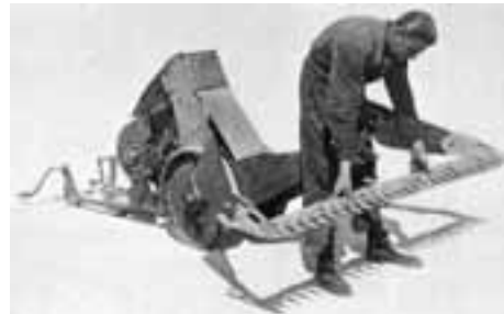
Beispiel der Balkenmontage in der Bedienungsanleitung für Rapid Motormäher der CEMSA in Italien.
