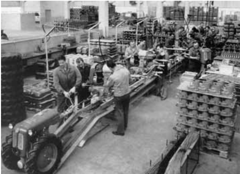
Montageband 4-Rad-Fahrzeuge mit geländegängigem Alltrac 450.
