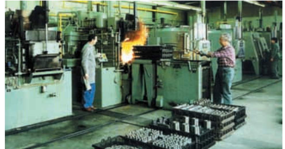
Durchstoss-Kammeröfen (Gasatmosphäre) im Betrieb Urdorf.
