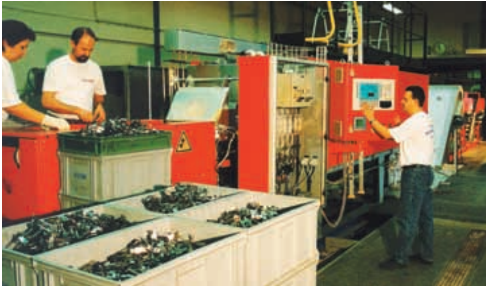
Härtedurchlaufofen mit Warmbadabschreckung.
