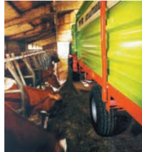
Mit den Dosierwalzen des Futtermischwagens wird die Silage direkt im Stall abgeladen.
