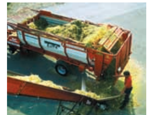
Pöttinger Erntedosierwagen mit seitlichem Auswurf.
