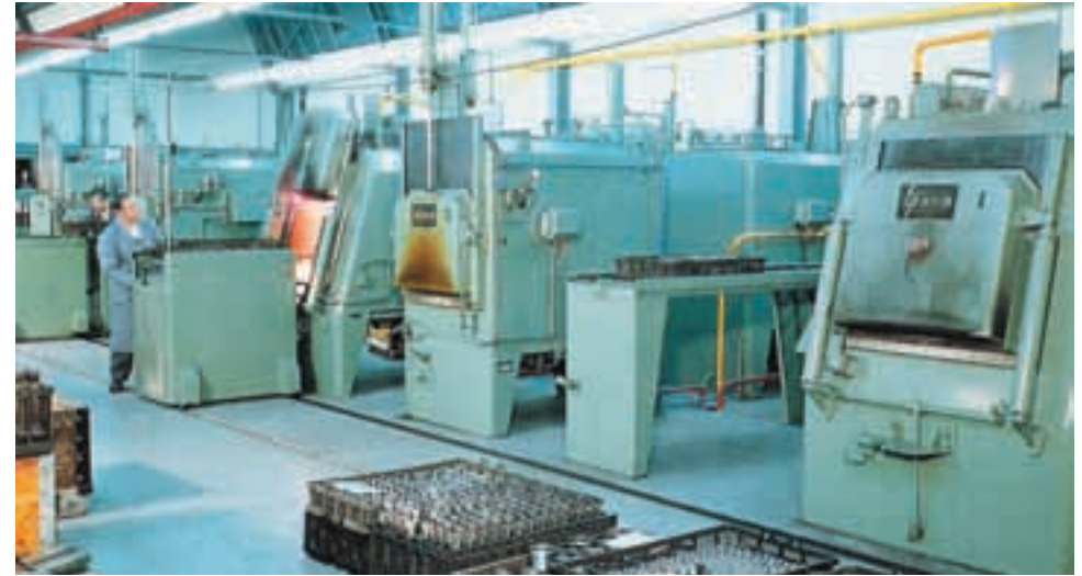
Durchstoss-Kammeröfen für das Einsatzhärten.
