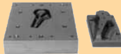
Gesenk für medizinisches Implantat aus Warmarbeitsstahl 1.2344.
