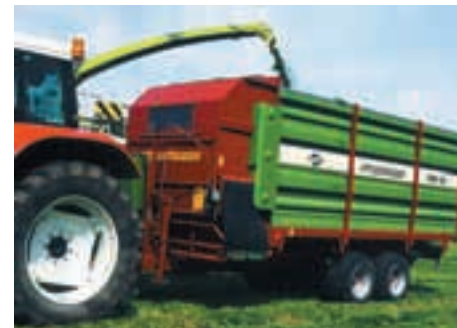
Der Futtermischwagen wird von oben befüllt.
