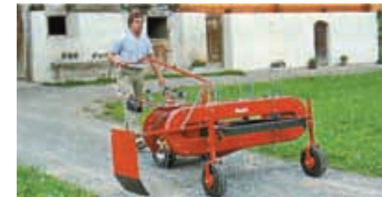
Rapid Mäher 306: Grosse Bodenfreiheit erleichtert das Fahren im Gelände.
