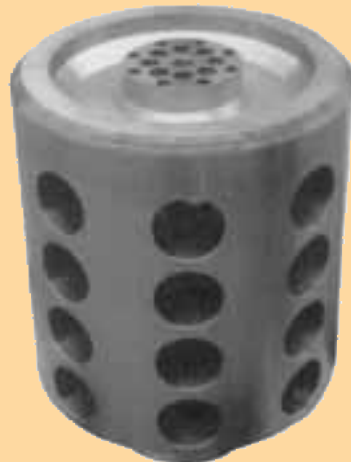
Rotor eines Hydromotors, 157 kg schwer und 500 mm hoch. Kurzzeitanitriert (KN).
