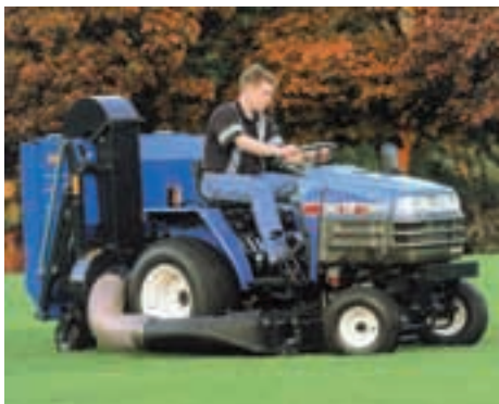
Kleintraktor Iseki mit Zwischenachs-Mähwerk und Grasabsaugung.
