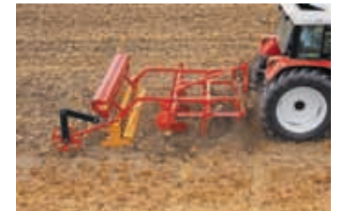
Pöttinger Grubber Synkro mit Zusatzausrüstung Zwischenfrucht-Sägerät.
