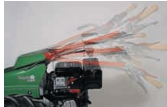
Einfache, zentrale Holmenhöhenverstellung für jede Bedienperson und anpassbar für jeden Einsatz.
