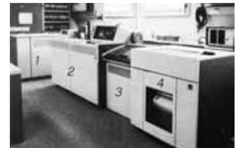
Die erste IBM S/38 mit Magnetplattenspeicher (1), Zentraleinheit IBM S/38 (2), Magnetband (3), Zeilendrucker (4) und 39 Bildschirmen (1983).
