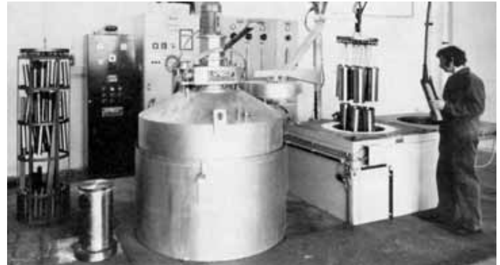
Gas-Nitrocarburieren in der Wirbelbett-Wärmebehandlungsanlage in Dürnten.
