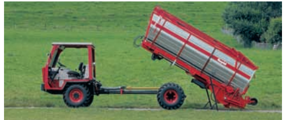
Heckklader werkzeuglos absattelbar.
