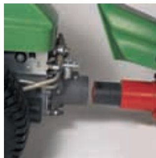
Werkzeugloses Schnellwechselsystem für Anbaugeräte.
