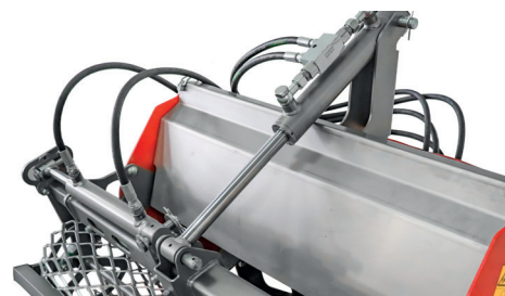
Réglage en hauteur et latéral hydraulique du rouleau suiveur en option
