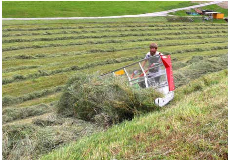
Resultat: Rückstandslose Aufnahme und Hangabwärtsfördern des getrockneten Erntegutes
