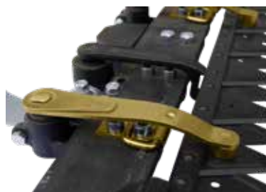
Leviers d'entraînement des couteaux supérieur et inférieur
