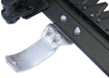
Sabot, réglable en continu jusqu'à environ 8 cm
