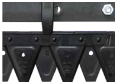
Barres de coupe à deux lames
