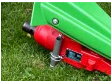
Support de démontage pour un attelage et un dételage faciles
