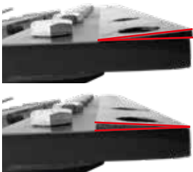
Cuneo per correggere l'inclinazione della barra falciante
