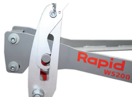
In Transport- oder Verladestellung, Wiesenschlepe fixiert
