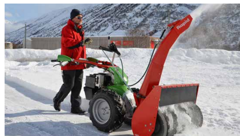
Regolazione della direzione di espulsione durante la marcia dal manubrio
