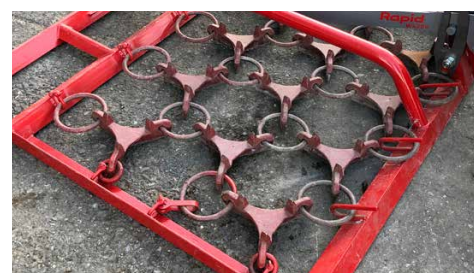
Stelle con elementi di collegamento e punte, utilizzabili su entrambi i lati
