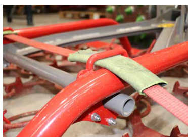
Sollevamento, carico, fissaggio Gli occhielli da gru e le alette per infilare cinghie di tensionamento consentono un'agevole sospensione e un fissaggio del carico affidabile.
